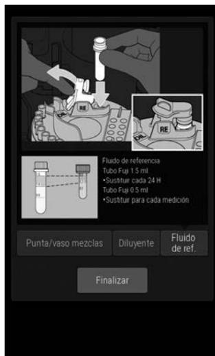
**NOTA** Toque el botón de accesorios en la pantalla superior y seleccione la pestaña de [Fluido de referencia] para visualizar la pantalla guía de ajuste del fluido. Esta operación no es necesaria porque solo se muestra la pantalla guía.
