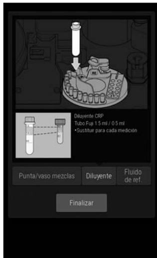
**NOTA** Toque el botón de accesorios en la pantalla superior y seleccione la pestaña del [Diluyente] para visualizar la pantalla guía de ajuste del diluyente. Esta operación no es necesaria porque solo se muestra la pantalla guía.
