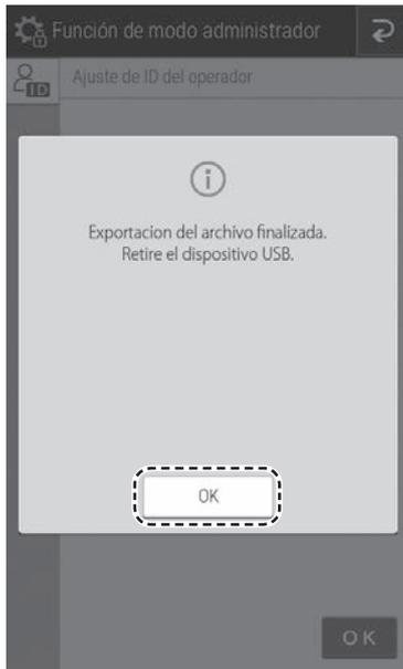
4. Una vez completada la exportación, aparecerá la ventana emergente de la izquierda. A continuación, pulse [OK] y desconecte el dispositivo USB.
