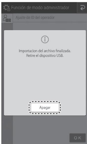
6. Una vez completada la importación, aparecerá la ventana emergente de la izquierda. Desconecte el dispositivo USB y pulse [Apagar].
