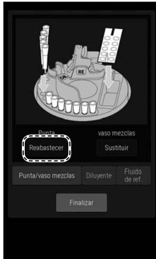
7. Compruebe que las puntas se hayan colocado en todos los orificios de la bandeja de puntas. Y a continuación, toque el botón [Reabastecer] de puntas.
