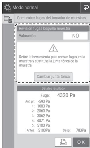
Si los resultados de comprobación son [NO], pulse el botón [Cambiar junta tórica] y, a continuación, sustituya la junta tórica de acuerdo con el siguiente procedimiento.
