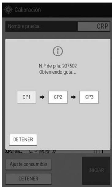
**11. Realice la medición del calibrador CP2. Realice de (b) a (d) del Paso 8, y a continuación pulse el botón [INICIAR].**
