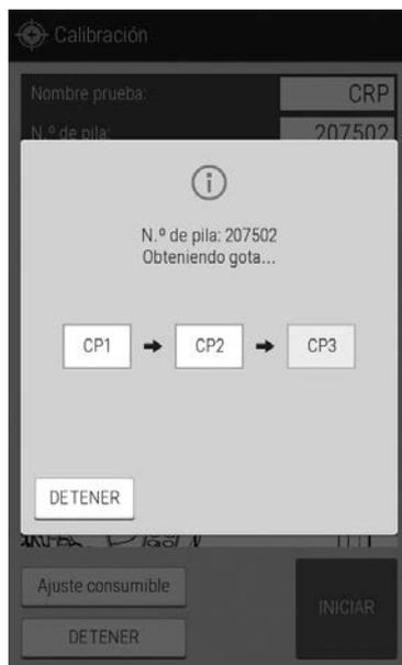
**12. Después del muestreo CP2, abra la cubierta, retire el CP2 de la bandeja de muestras y a continuación, cierre la cubierta firmemente.**
