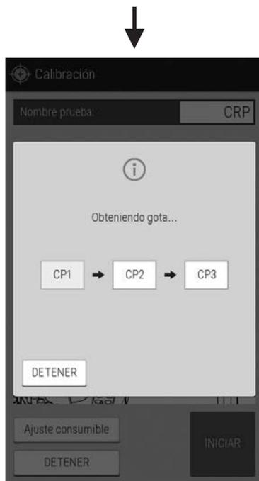
10. Después del muestreo CP1, abra la cubierta del equipo, retire el CP1 de la bandeja de muestras y a continuación, cierre la cubierta firmemente.
