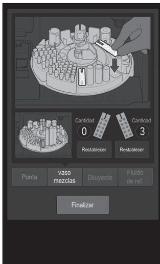
**NOTA** La cantidad de copas de mezcla que puede usarse se muestra en la pantalla LCD. Si la cantidad restante no es suficiente, resultará imposible realizar la medición de dilución.
