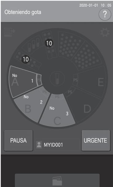
La sección del soporte de muestras parpadea durante la aplicación de muestras.
