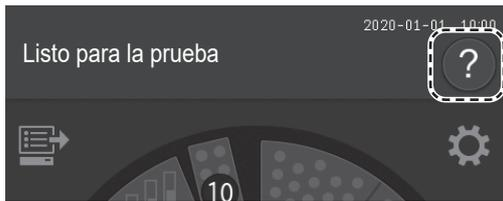
Durante la medición, el mantenimiento, el intercambio de accesorios y otras acciones en el FDC NX700, puede pulsar el botón **?** de la pantalla de preparación de mediciones para comprobar los procedimientos.
