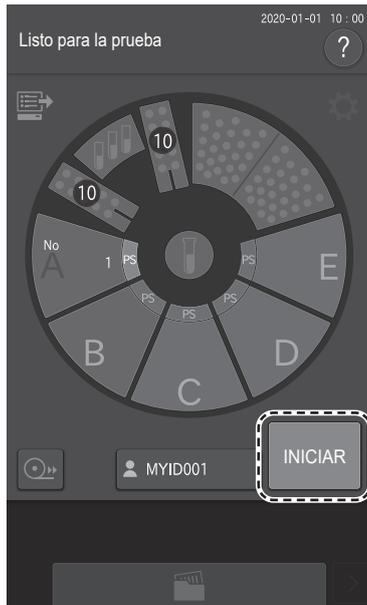
5. En la pantalla de preparación de las mediciones, pulse el botón [INICIAR] para comenzar la medición.
