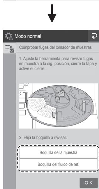
5. Pulse la boquilla que debe comprobarse para seleccionarla y, a continuación, realice la comprobación de fugas.
