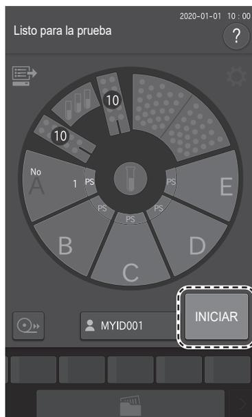
**7. En la pantalla de preparación de las mediciones, pulse el botón [INICIAR] para comenzar la medición.**
