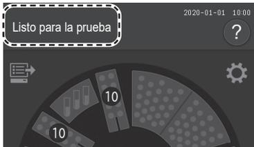
Si aparece el mensaje [Listo para la prueba] en la pantalla LCD, asegúrese de que el analizador no está aplicando muestras.
