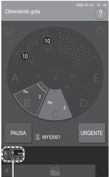
Cuando la aplicación de muestras finaliza, la sección de la bandeja de muestras se apaga. Cuando se han cargado slides y muestras en múltiples soportes de muestras, la sección del siguiente soporte de muestras parpadea en color naranja y se inicia la aplicación de muestras.
