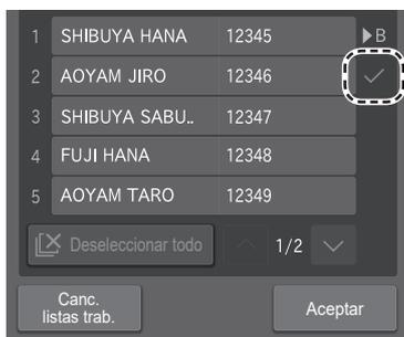
**NOTA** Con la versión de software 2.0 o posterior instalada, se puede registrar una solicitud de medición en varias bandejas de muestras. En este caso, se indica en el borde derecho de la lista de trabajo.
