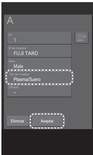
5. Pulse una sección de la bandeja de muestras. En la pantalla de registro de información de muestra, registre la información de medición y, a continuación, pulse el botón [Aceptar].
